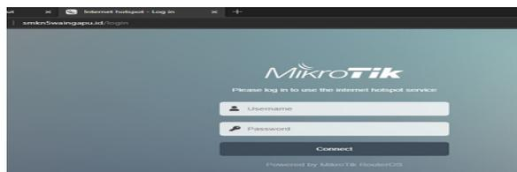
Gambar 4, merupakan proses untuk melakukan *login* dengan lakukan pengetesan dengan cara hubungkan laptop pada WIFI mikrotik, maka akan muncul secara otomatis *redirect* ke halaman *login*. Gunakan *username* dan *password* yang telah ditentukan, setelah *login* akan, mendapatkan akses internet sepenuhnya.
