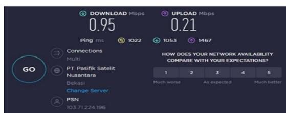
Gambar 7, merupakan tampilan hasil pengujian *speedtest* setelah terjadinya proses manajemen *bandwidth* untuk *user hotspot* guru. Berdasarkan hasil uji yang telah dilakukan membuktikan bahwa proses manajemen *bandwidth* yang dilakukan berjalan dengan baik. Dimana nilai rata-rata dari *bandwidth* untuk proses *download* sebesar 0.95 Mbps dan *upload* sebesar 0.21 Mbps hal ini berarti *bandwidth* yang dibagikan untuk setiap *client* sudah termanajemen secara merata.
