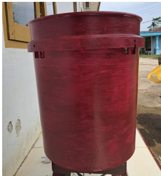
Gambar 2. Tabung pencacah pakan yang digunakan sebagai wadah utama.
