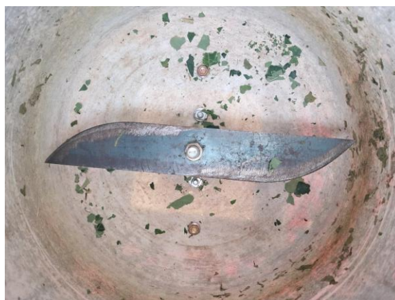
Gambar 4. Pisau pencacah yang dipasang di bagian bawah tabung pencacah.
