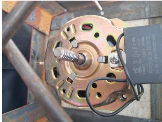
Gambar 5. Motor listrik sebagai penggerak pisau pencacah.
