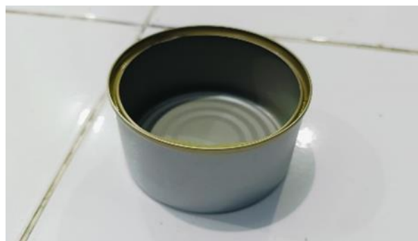
Gambar 3. Kaleng yang lolos uji (normal)
