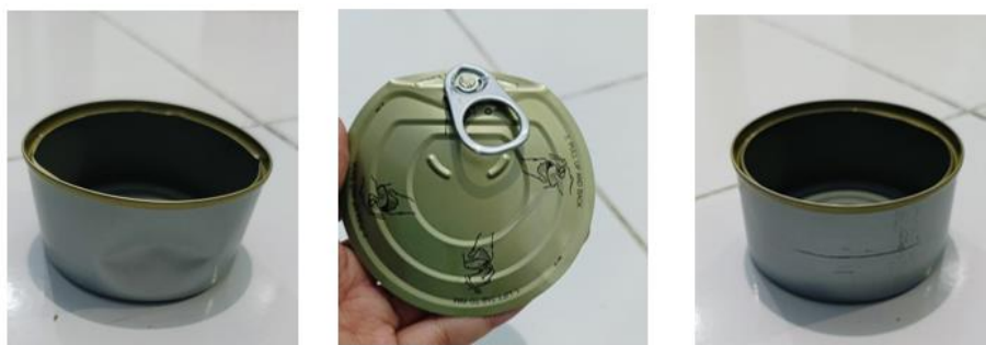
Gambar 4. Kaleng Penyok pada Bagian Body, Gores Lid dan Gores Body
