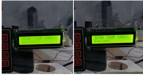
Gambar 12. Output LCD Ketika berhasil dan gagal
